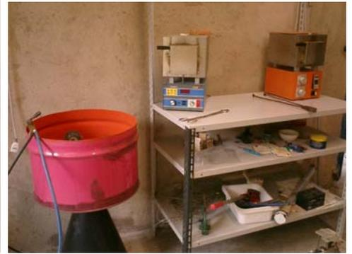
Centrifuga e forni per la cottura del rivestimento
