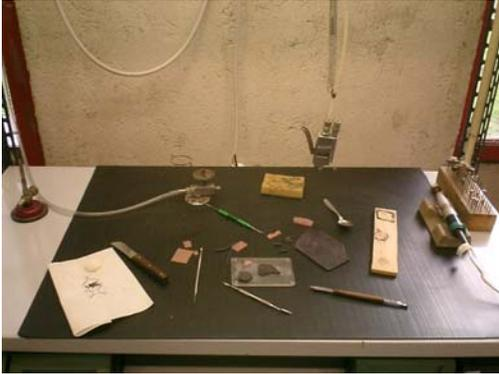
Attrezzatura per la lavorazione della cera, micromotore per l'utilizzo delle frese
