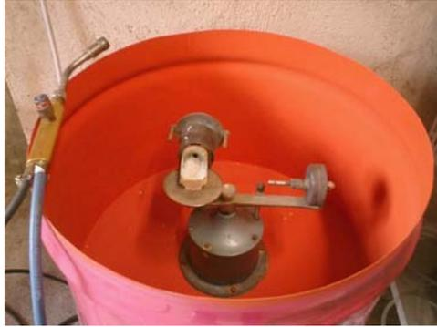
Centrifuga per l'iniezione dell'oro e cannello per la fusione dell'oro
